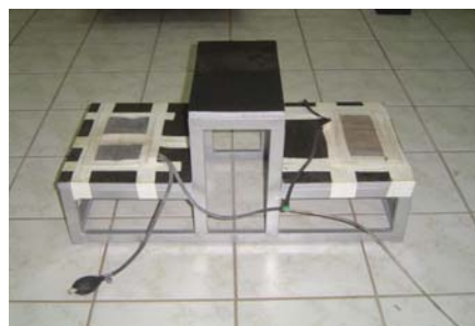
Figura 2 – Vista lateral da escada. Note dois manguitos de pressão fixados com esparadrapo nos dois degraus inferiores.
